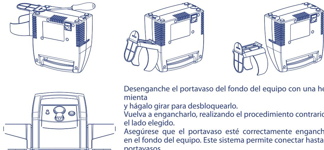
Desenganche el portavaso del fondo del equipo con una herramienta y hágalo girar para desbloquearlo.
