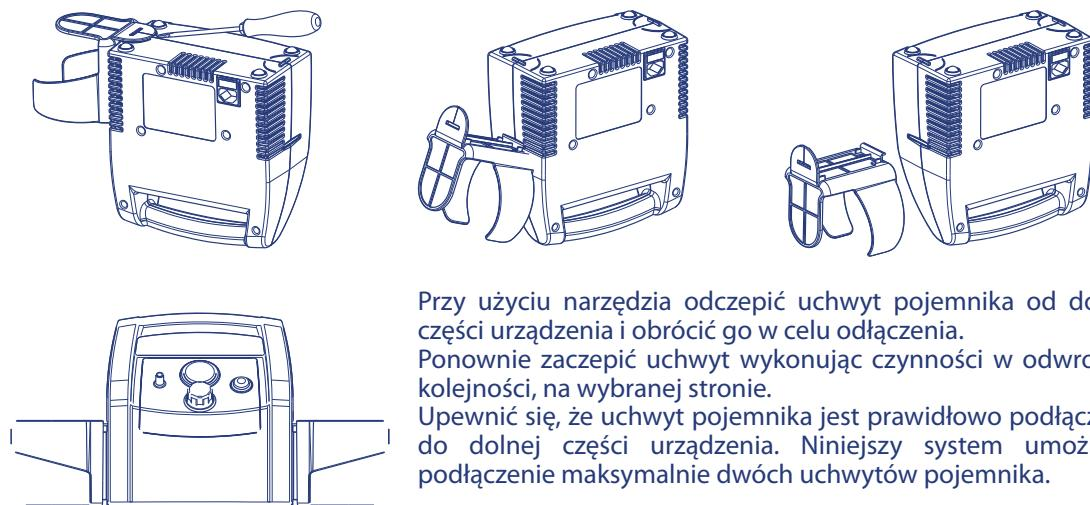
Przy użyciu narzędzia odczepić uchwyt pojemnika od dolnej części urządzenia i obrócić go w celu odłączenia. Ponownie zaczepić uchwyt wykonując czynności w odwrotnej kolejności, na wybranej stronie. Upewnić się, że uchwyt pojemnika jest prawidłowo podłączony do dolnej części urządzenia. Niniejszy system umożliwia podłączenie maksymalnie dwóch uchwytów pojemnika.
